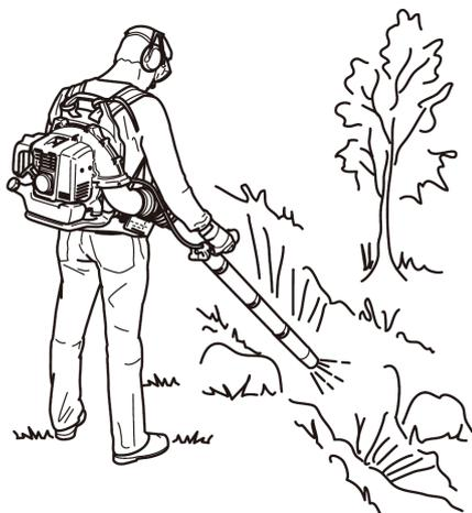
Скорость двигателя должна быть отрегулирована в соответствии с типом удаляемого материала, редко требуется использовать полный газ, и многие рабочие операции можно выполнять при половине скорости:
